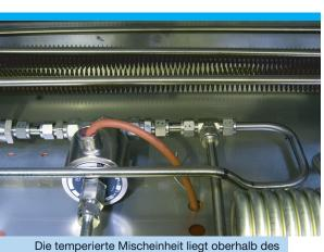
Die temperierte Mischeinheit liegt oberhalb des Verdampfers. Das schnell und präzise steuerbare Verhältnis trockener und feuchter Gase sorgt für exakt definierte Atmosphären.
